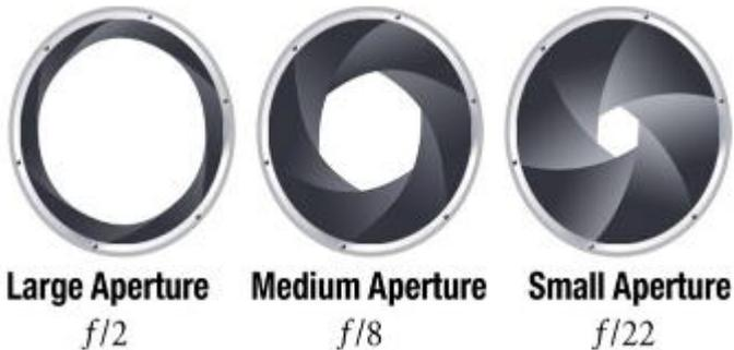
**Большая глубина поля при малой апертуре (высокое значение  $f$ /число), чем при большой апертуре (низкое значение  $f$ /число)**
